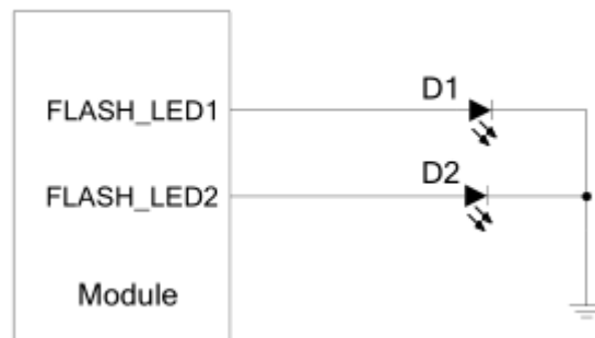
图 31 Flash light 接口参考电路
